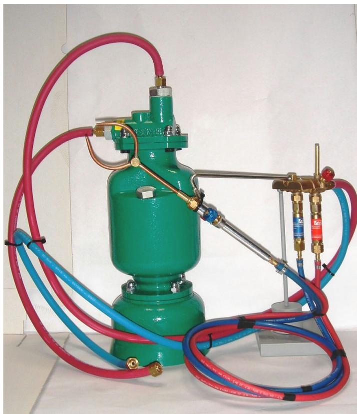
Компания КСМ представляет технология подачи флюса в пламя: жидкий флюс, бочек, аксессуары, припой. Пайка под газовым флюсом. Широко применяется при пайке медь-медь, медь-латунь, медь-сталь, сталь-сталь (холодильная техника, кондиционирование, металлоизделия, ювелирная промышленность)
