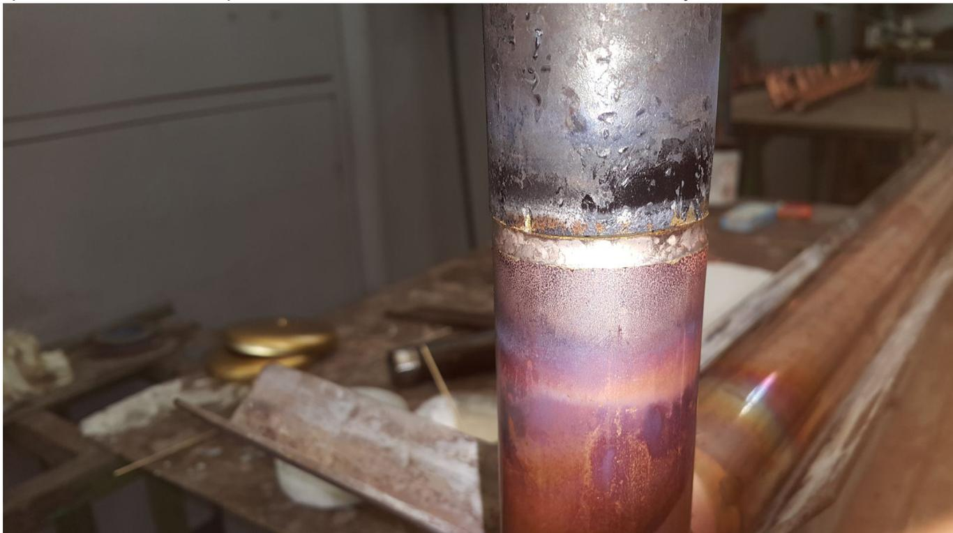
Отказ от флюсованных припоев или порошков и паст может значительно снизить расход припоя и значительно сэкономить на последующей очистке. Типичные применения: производство автокомплектующих, карбидных инструментов, металлической мебели. В холодильной технике и кондиционировании (производство коллекторов теплообменников) технология используется для соединений медь-сталь.
