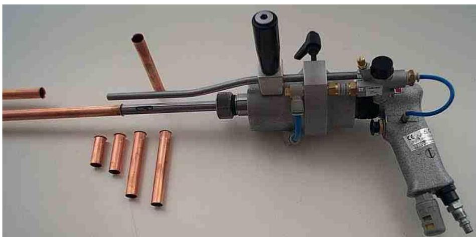
Профессиональный инструмент (пневматическая дрель) для изготовителей теплообменников. Дрель формует колокол для калача и обрезает медную трубку после дорновки. Также поставляется в варианте просто подрезки изнутри.
