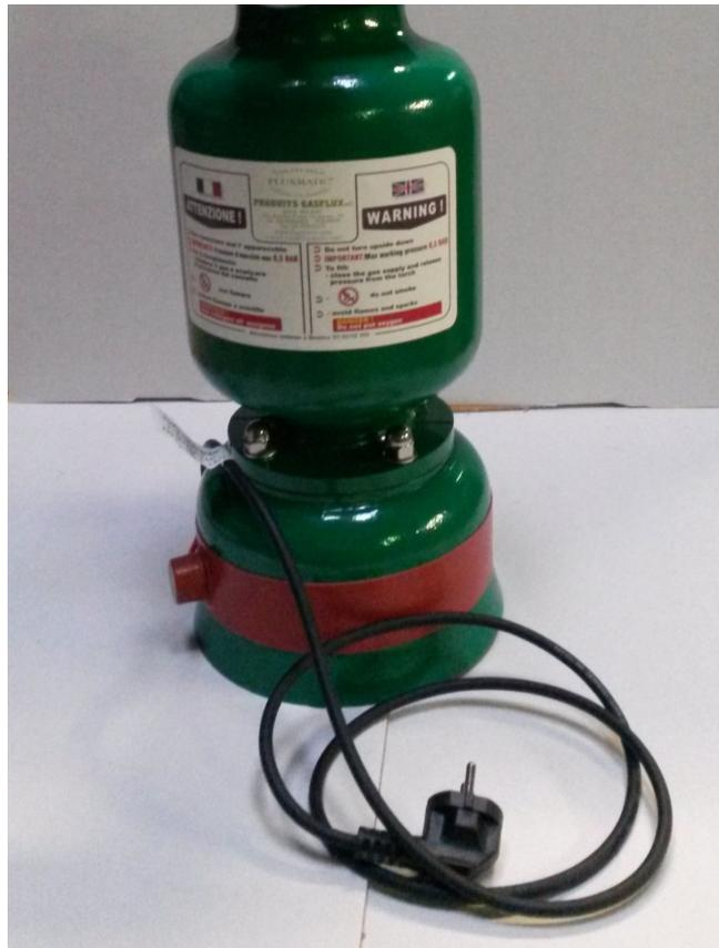
Технология газфлюс плохо работает при пониженных температурах (ниже +16С). Поэтому если у Вас есть “сезонность” в качестве пайки, мы предлагаем электрический нагреватель с термостатом, который поддерживает постоянную оптимальную температуру флюса.
